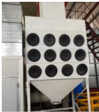
喷砂室滤筒除尘器
